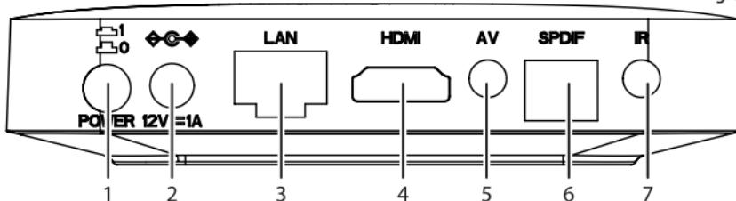
1. Spínač zapnutia/vypnutia napájania
